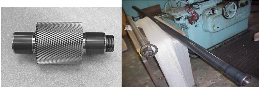
图 2. 经过热喷涂的纳米结构氧化物陶瓷涂层的美国海军潜艇部件
