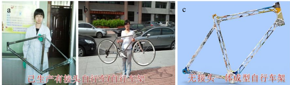
图 1 报纸增强树脂基复合材料自行车。(a)喷车架原貌，女士也只需要一根手指就能将其举起；(b) 组装后报纸复合材料自行车；(c) 一体成型（无接头）自行车架效果图。
